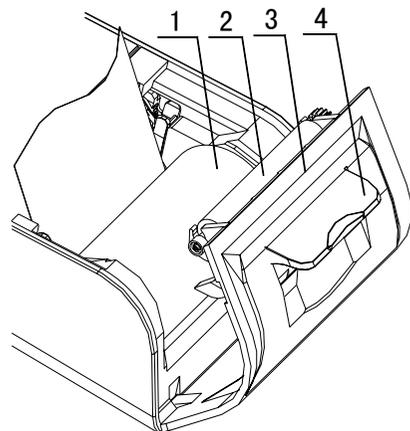
1. 纸卷 2 纸辊 3 纸仓盖 4 开仓机构
