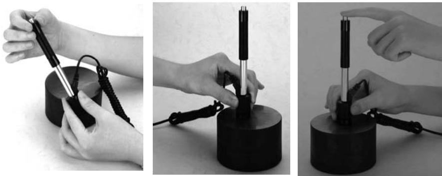
向下推动加载套锁住冲击体；对于 DC 型冲击装置，则可将加载杆吸于试验表面，将 DC 型冲击装置插入加载杆，直到停止位置为止，此时就完成了加载。
