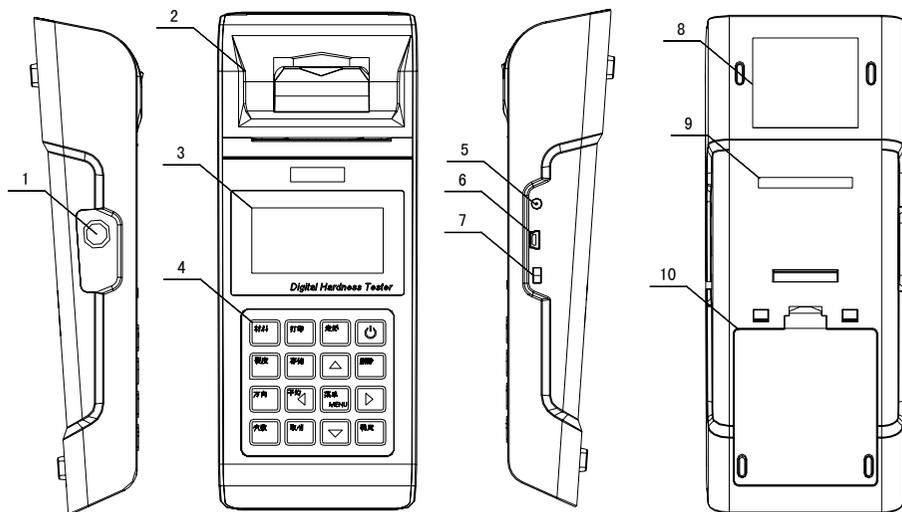
1 冲击装置插座 2 打印仓盖 3 液晶显示屏
