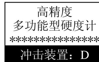
仪器会检测冲击装置类型并显示，此时请注意观察是否正确，然后进入测量主显示界面。
